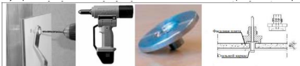
Устройство центровки отверстия в направляющей относительно отверстия в плите
